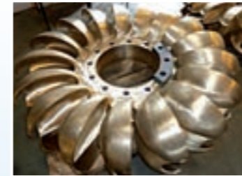
Roue Pelton réparée en Cupro-Aluminium
